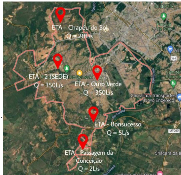
Figura 1 Mapa do município de Várzea Grande – MT e a localização das ETAs com suas respectivas vazões de trabalho. Fonte: Google Maps
